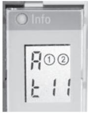
スタートアップフェイズに従い、上部左のディスプレイは運転モード A を表示します。ループシンボルは、ベーシック機能セットの真下に隣接して表示されています。左のボタン a は "t"、タイム機能がプログラムされているか否かを表示しています。これで目的とする対象物によるループ稼働の機能が確認出来ます。もしループが稼働の場合、出力リレーは選ばれている機能により、スイッチオン、もしくはオフでなければなりません。
